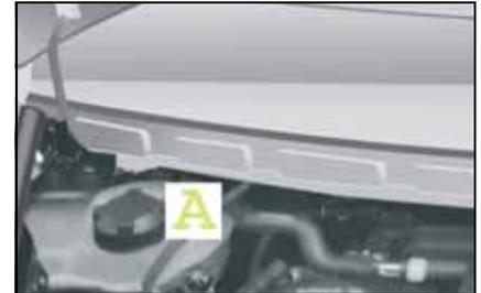
Einfüllöffnung beim Dieselmotor
